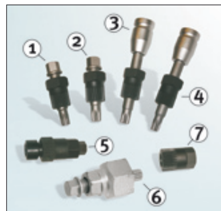
Fig. 5: Benodigde speciale gereedschappen voor uit- en inbouw van diverse vrijloopriemschijven
