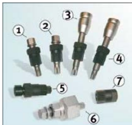
Рис. 5: Специальный инструмент для установки и снятия различных обгонных муфт.
