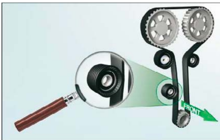
Рис. 1: Траектория ремня и позиция ролика на двигателе F4R
