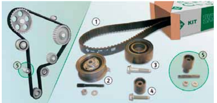
Şekil 1: 1.9 TDI/SDI motorun ana tahrik düzeni ve 530 0361 10 / 530 0082 10 referanslı INA triger kiti
