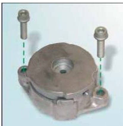
Рис 1: Конструкция INA с 2 болтами M8x35
