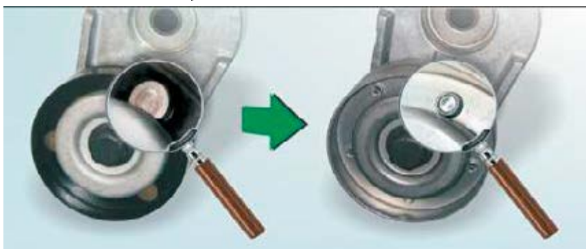
Рис 1: Увеличенный вид различий роликов предыдущей конструкции (слева) и новой конструкции (справа)
