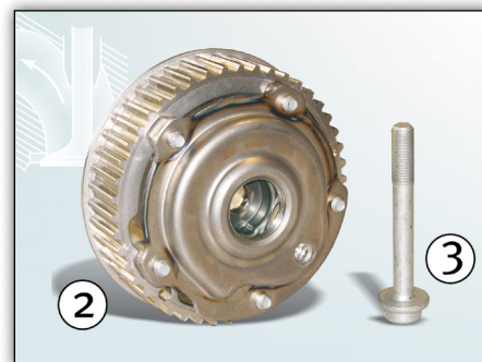
Bild 2: Kamaxeljustering avgassida 427 1005 10 och centralskruv 41301*
