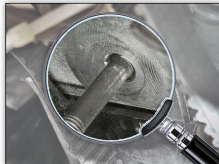
Figur 2: Støtteboltens er skruet korrekt.
