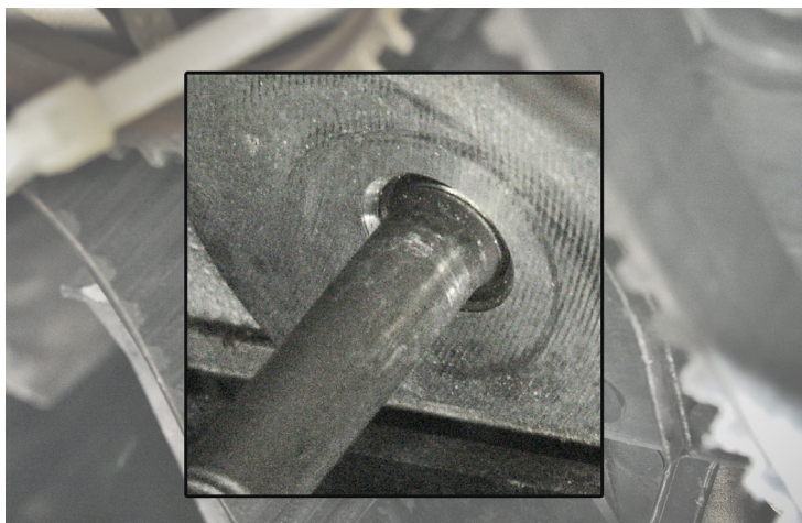
Kuva 2: Pinnapultti on oikein kierretty
