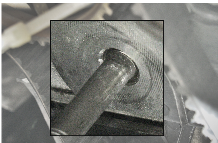
2. ábra: A tőcsavar megfelelően van becsavarva
