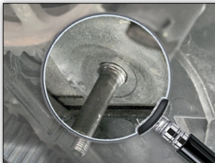
Fig. 1: De tapbout is niet correct ingeschroefd.
