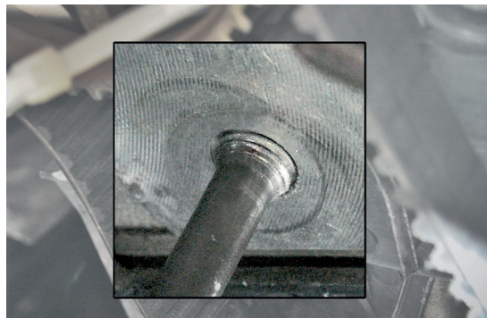
Bild 1: Pinnbulten felaktigt inskruvad
