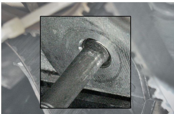
Bild 2: Pinnbulten är korrekt inskruvad
