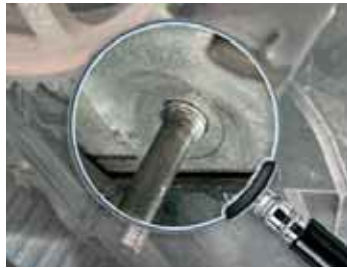
Şekil 1: Saplama doğru şekilde takılmamış.
