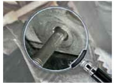
Şekil 2: Saplama doğru şekilde takılmış.
