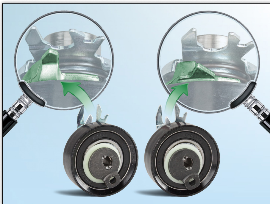
Figur 2: Forskelle i strammerulle 531 0252 30 (til venstre) og 531 0525 30 (til højre)
