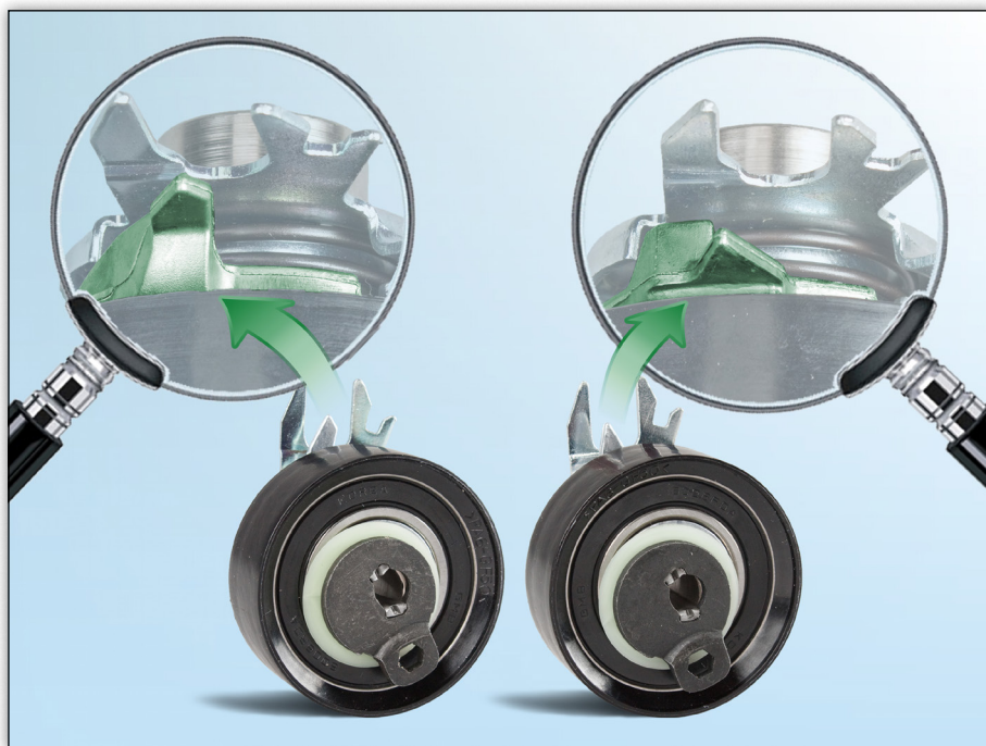
Εικόνα : διαχωρισμός μεταξύ των τεντωτήρων 531 0252 30 (αριστερά) και 531 0525 30 (δεξιά)
