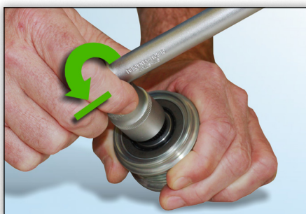
Figur 4: Mod uret blokerer værktøjet direkte og kan ikke drejes.
