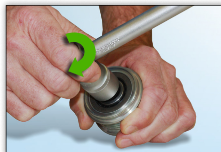
Figur 5: Med uret kan værktøjet drejes med en let modstand og uden begrænsning.
