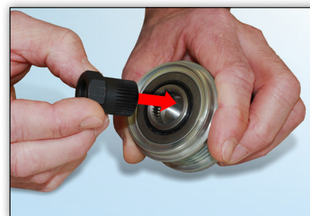
Figur 3: Adapteren skal indsættes i friløbshjulets remskive.
