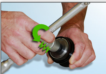
Kuva 6: Kierrettäessä sisäosaa vastapäivään tuntuu kasvava jousivoima.
