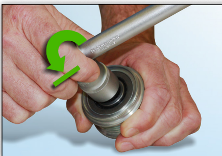
Kuva 4: Kierrettäessä sisäosaa vastapäivään on vapaapyörän lukituttava.
