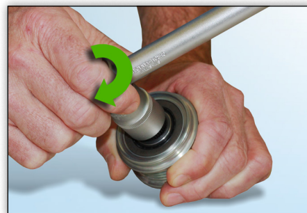
Kuva 5: Kierrettäessä sisäosaa myötäpäivään tulee vapaapyörän kiertyä vapaasti.
