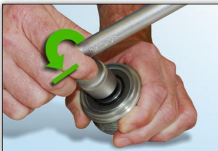
**Figura 4:** In senso antiorario l'utensile si blocca direttamente e non è più possibile ruotarlo.
