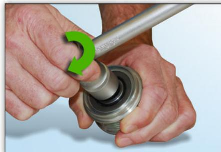
**Figura 5:** L'utensile può essere facilmente ruotato in senso orario esercitando una leggera resistenza.
