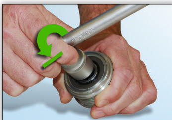
Figur 4: Verktøyet låses umiddelbart og kan ikke dreies rundt når det beveges mot klokken retning.
