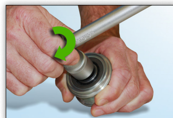
Figur 5: Verktøyet kan kontinuerlig dreies i klokken retning med litt motstand.
