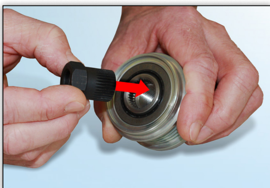
Figur 3: Den tilsvarende adapteren er satt inn i friløpremskiven.
