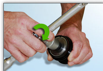
Figur 7: Verktøyet kan kontinuerlig dreies i klokken retning med litt motstand.
