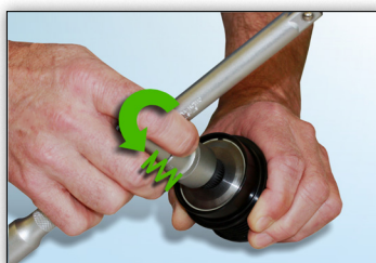
Figur 6: Du vil merke en økende fjærkraft når verktøyet beveges mot klokken retning.
