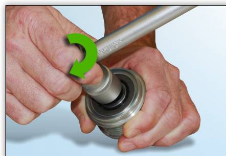
Obrázok 5: V smere hodinových ručičiek možno náradím otáčať s ľahkým odporom bez obmedzenia.
