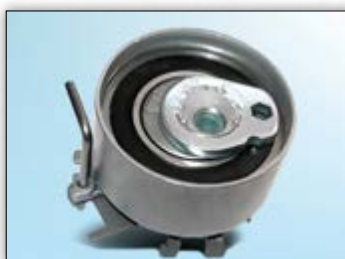
Рисунок 1: Прежняя конструкция из металла
