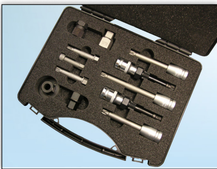
Figur 3: INA- specielværktøj, komponent-nr. 400 0241 10
