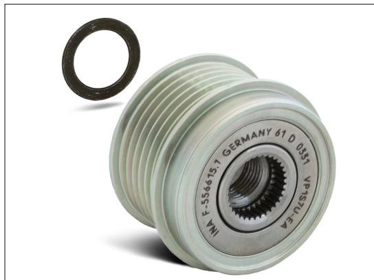
Figur 2: Ved montering af friløbshjulet til en Bosch generator skal man bruge den vedlagte 1,4 mm afstandsskive!
