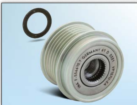
3. ábra: A generátor-szabadonfutónak egy Bosch-generátorba (Ford Transit) történő beszerelésekor a mellékelt 1,4mm vastag távtartót kell használni!
