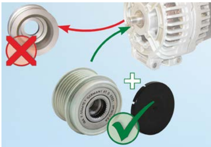
Рисунок 1: Замена цельного шкива на шкив генератора с обгонной муфтой
