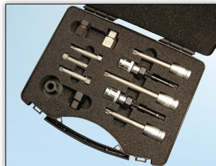
Εικόνα 3: Ειδικό εργαλείο INA με κωδικό 400 0241 10
