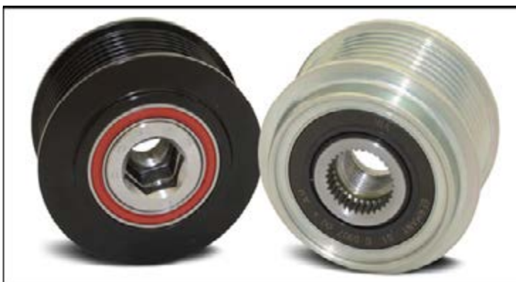
Рис. 2: При установке шкива генератора с обгонной муфтой на генератор Visteon (Ford Mondeo III) необходимо использовать прокладку толщиной 3 мм!
