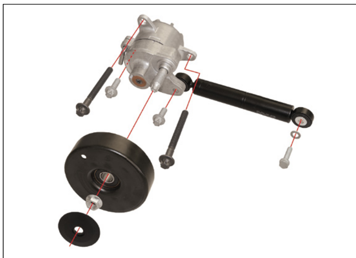
Рис. 1: 533 0116 10 – ремкомплект привода вспомогательных агрегатов INA включает все необходимые монтажные элементы.
