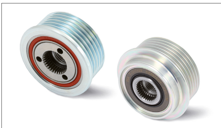
Fig. 1: Diferențe de ordin vizual ale fuliei de alternator cu sistem de rolă liberă 535 0238 10
