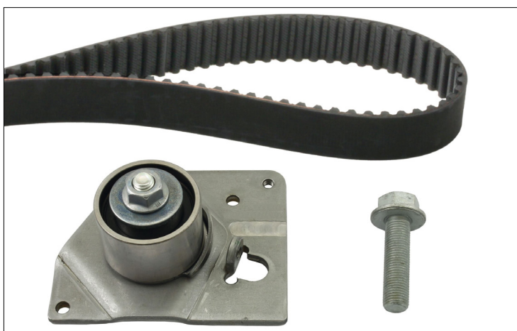
Снимка 1: 530 0196 10 – INA ремонтен комплект за ремъчно задвижване с ангренажен ремък 536 0278 10, обтяжна ролка 533 0087 20 и болт за колянния вал
