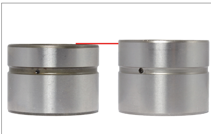
Fig. 1: Tchet hidraulic tip cupă: stânga: versiunea veche, dreapta: nou model
