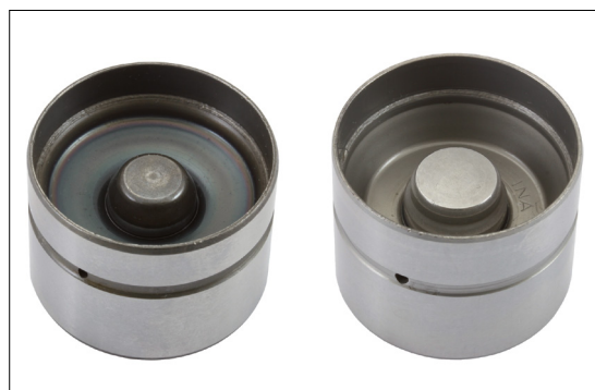
Obrázek 2: hydraulická misková zdvihátka, vlevo je staré provedení, vpravo je nové provedení
