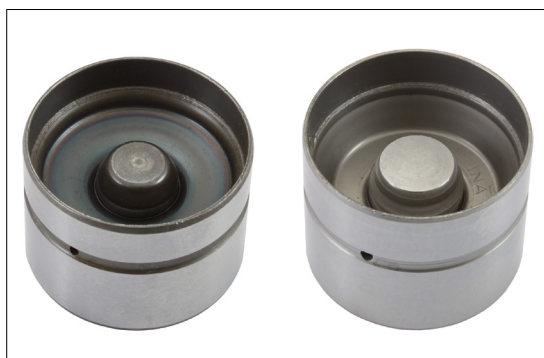
Εικόνα 2: Υδραυλικό ωστήριο, αριστερά: παλιά έκδοση, δεξιά: νέας έκδοσης
