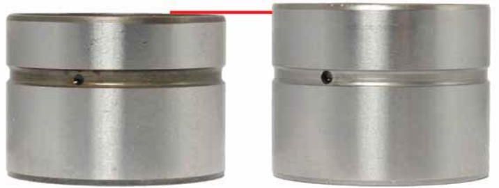
Şekil 1: Hidrolik supap, sol - eski versiyon, sağ - yeni versiyon
