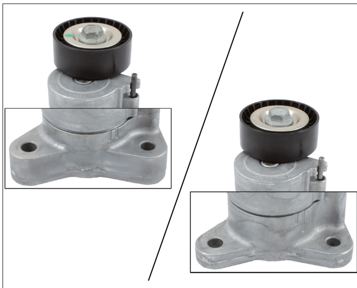
3. ábra: Balra, régi kivitel széles rögzítési pontokkal. Jobbra, új kivitel keskeny rögzítési pontokkal.
