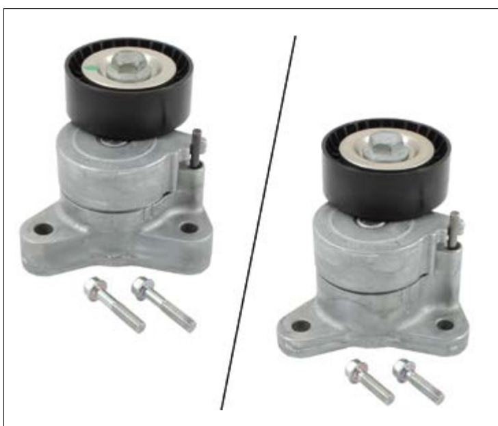
Рисунок 1: Натяжная планка 534 0325 10 – слева, старое исполнение с крепежными винтами M8x40. Справа, новое исполнение с крепежными винтами M8x30.
