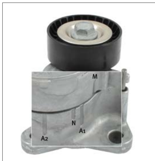
Рисунок 2: Улучшенные указатели рабочего диапазона натяжной планки.
