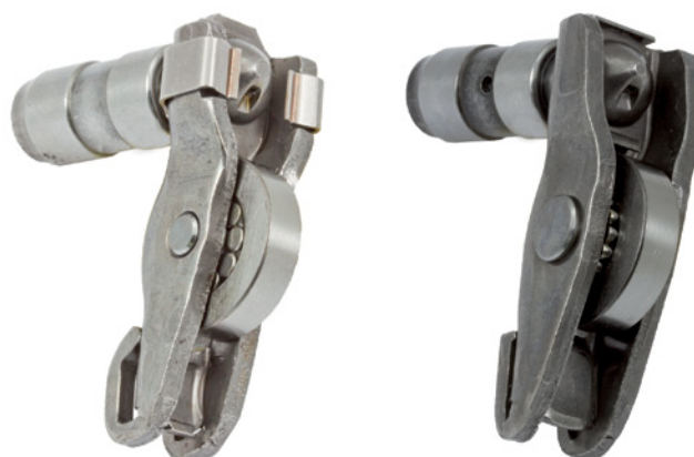
Fig. 1: 423 0076 10 – Links de oude uitvoering, rechts de nieuwe uitvoering
