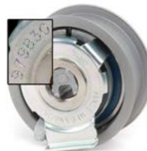
Рисунок 2: 531 0851 10 – новый натяжной ролик (979830)
