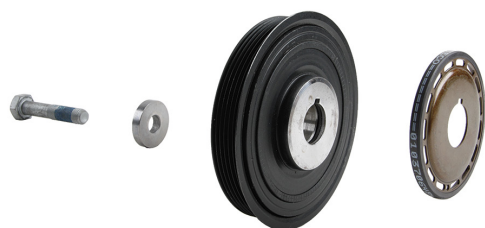
Fig. 2: Senzor de impulsuri și amortizor de vibrații ale arborelui cotit
