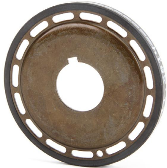
Der Impulsgeber für das Motormanagement (Bild 1) lässt sich, auf Grund der Materialpaarung, oft nur sehr schwer vom ausgebauten Kurbelwellenschwingungsdämpfer (Bild 2) lösen.
