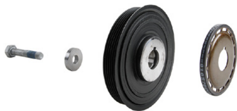
Figura 2: Sensore a impulsi per lo smorzatore di vibrazioni dell'albero motore
