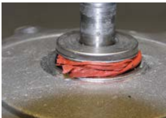
Fig. 1: Garnitură solidificată pe axul pompei între carcasă și rotor (ansamblu demontat)
