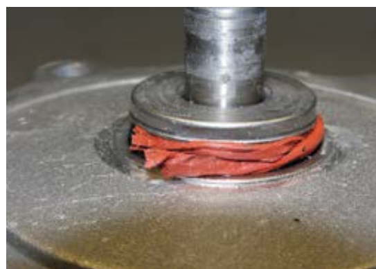
תמונה 1: משאבת מים עם שארית אטם נוקשה על הציר בין בית המשאבה לשבשבת (אימפלר אשר התפרק)
