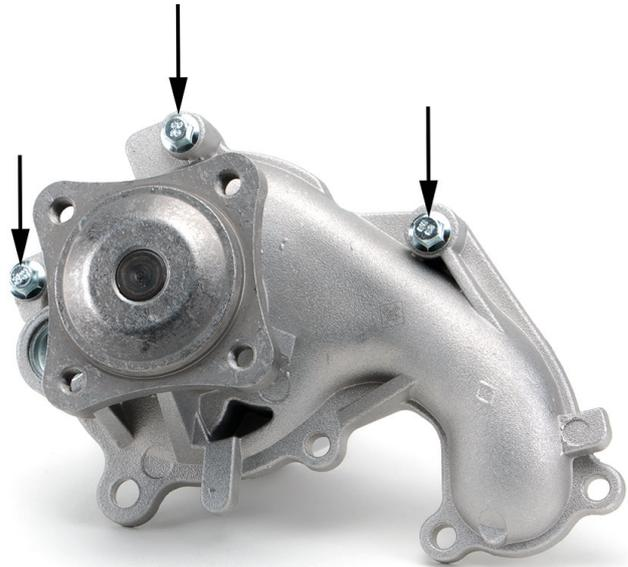
Bild 2: Modifizierte Befestigungspunkte der Kühlmittelpumpe
