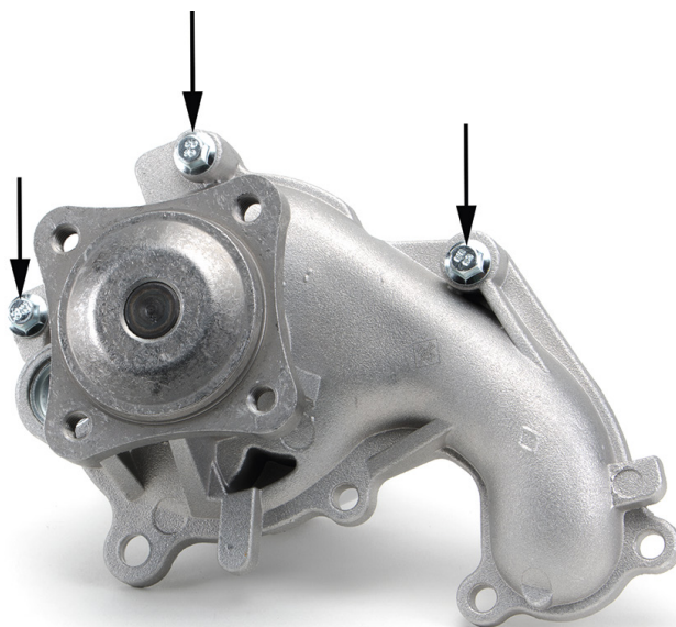
Kuva 2: Jäähdytysnestepumpun modifioidut kiinnityspisteet
