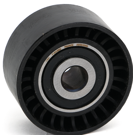
Photo 1 : Ancienne version avec chemin de roulement en plastique
