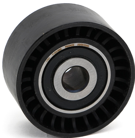
Slika 1: Stara izvedba s plastičnim kolotuirom
