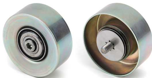
Photo 1 : Poulie de renvoi avec l'ancienne étanchéité
