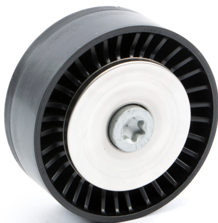
Figura 1: Versione precedente con disco di protezione
