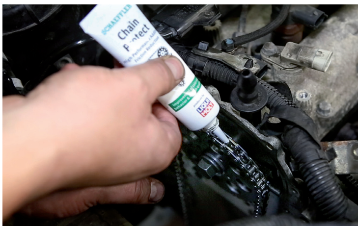
Снимка 2 Schaeffler Chain Protect се прилага за всички компоненти на ангренажната веригата по време на монтажа.
